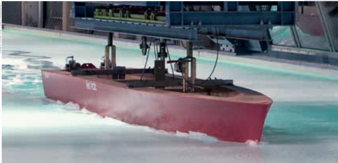
■ Mallikokeilla on pyritty optimoimaan rungon muodot niin avovesi- kuin jääolosuhteisiin.
